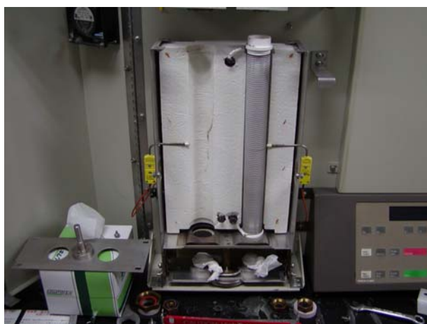
図 9 燃焼温度が 1800℃ 以上になるヒーター部の取替。
