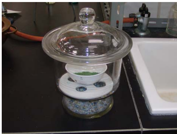
図 7 加熱後は、試薬が水分を吸収しないようにデシケーター内で冷却し、反応管に充填する。
