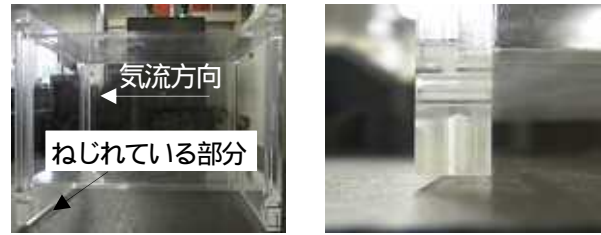
(a) 出口部のサイドビュー (b) ねじれの拡大図 図7 接着による出口部のねじれ
