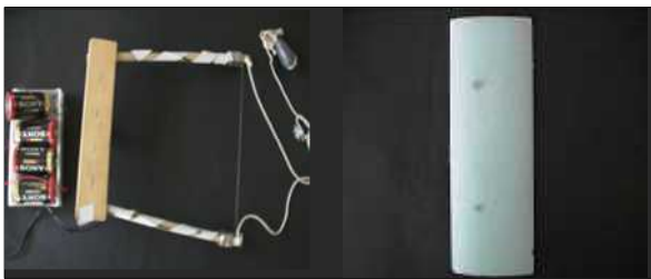
図6 半自動ヒートカッター(左)と製作した翼(右)
