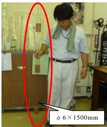
写真 13 マノメーター (U字管)
