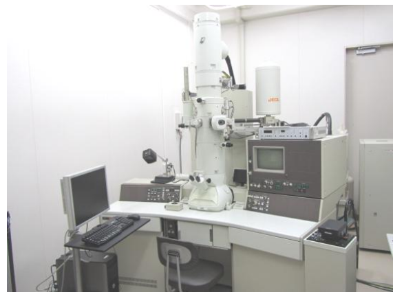
図 9 透過電子顕微鏡 (JEM-2010)
