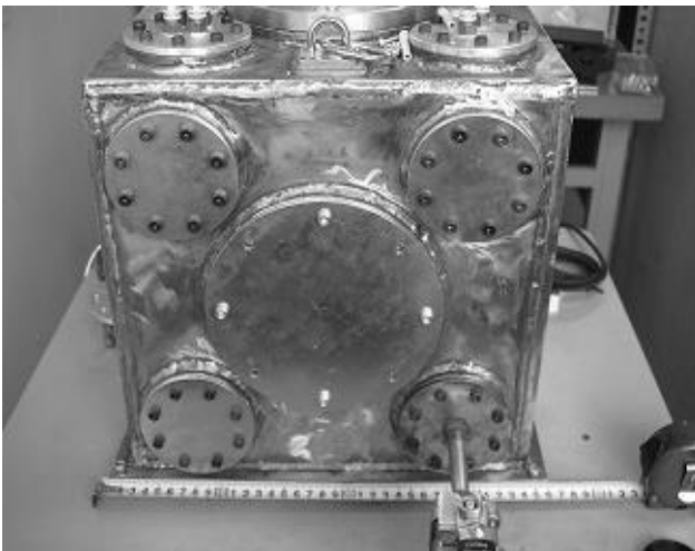
図1 真空チャンバー (SUS304 300×300×300)
