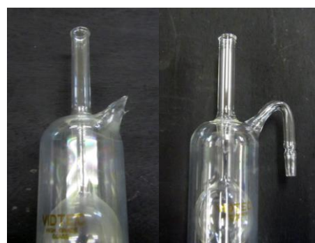
写真5 冷却器 (左: 修復前、修復後)
