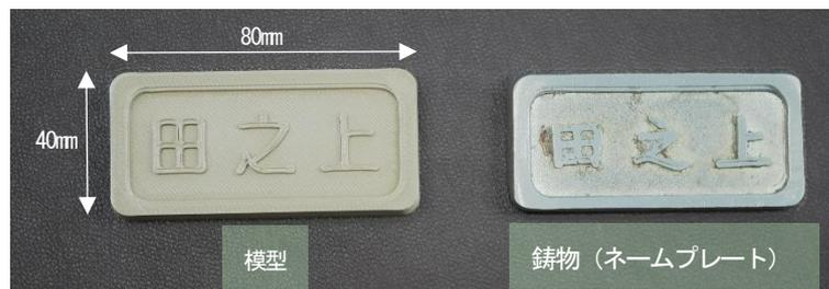
図2 3Dプリンターで製作した模型とオリジナル鋳物
