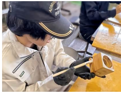
図3 木固め材の塗布
